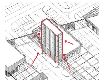
verlichten vanaf de daken dmv. spots/stralers notes: armaturen nodig met hoge output, zeer exact spotten
